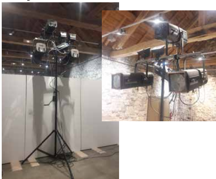
Le pied lumière de Face, 3 découpes 1kW, 2 Quartz (lumière public), 1 bloc grada 4 circuits.
